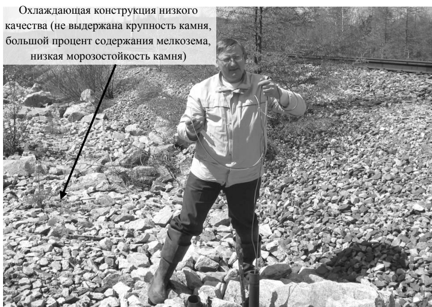
Рис. 2 – Погружение логгера и термокосы в скважину № 6, май 2013 г., «Км 2339» перегона Курьян-Тында.
